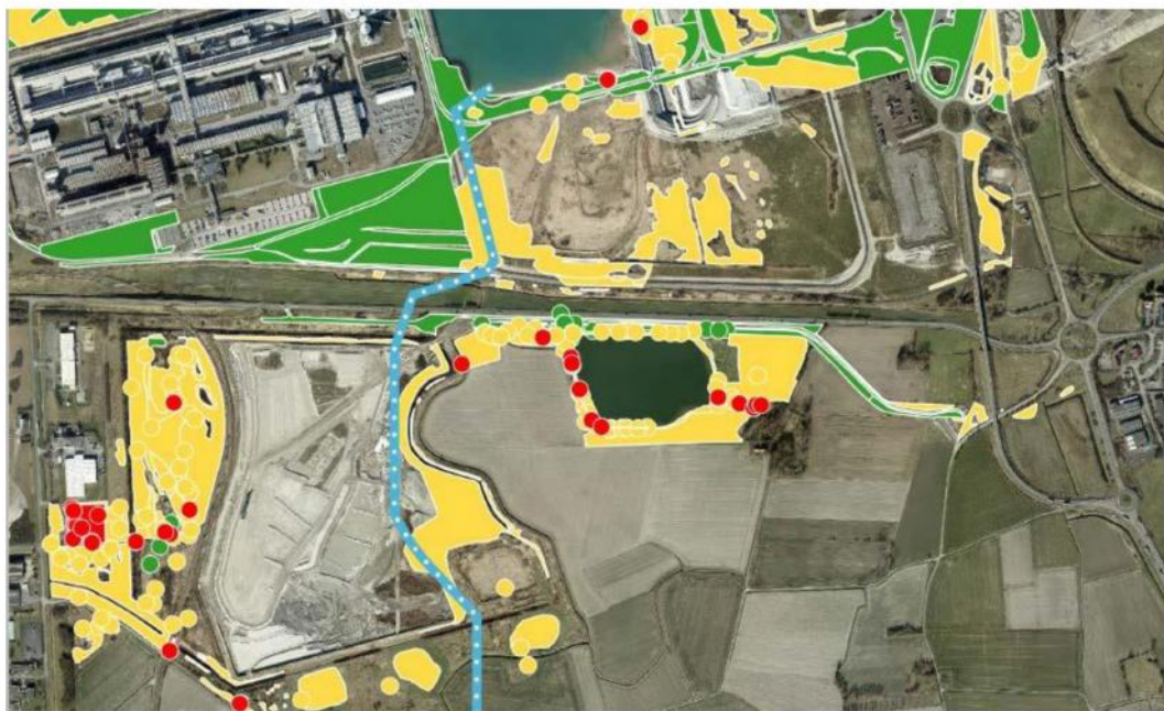
Figure 5 : Tracé nord de la canalisation des eaux traitées (l'usine et sa station d'épuration sont au sud de cette figure et n'y figurent pas) (source : dossier)
